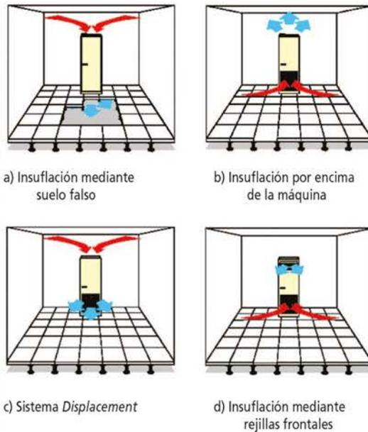
1. Sistema displacement: Define un método de distribución de aire en el que el aire refrigerado es insuflado a baja velocidad al nivel del suelo. El movimiento del aire se hace por convección como resultado de la carga térmica existente en la sala.
