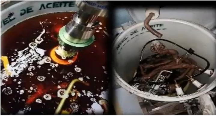
Con esta descontaminación de los equipos se puede recuperar el transformador según ASTM 3487: reacondicionamiento y certificación, pero desde ya el equipo queda mucho propenso a que se contamine fácilmente, y durante el tiempo que estuvo con el aceite contaminado se pudo a ver dañado el equipo, sale mucho más costoso y en Bolivia no se cuenta con empresas que hagan este tipo de trabajos.
