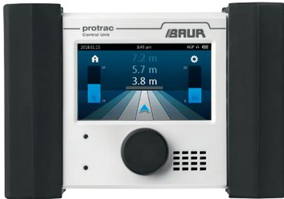
La unidad de mando permite navegar de manera clara e intuitiva hasta la avería gracias a su indicador en 3D. La indicación de la distancia y dirección en que se encuentra la avería sirve, junto con el historial, para conducir al usuario de manera segura y rápida hasta el punto de la avería.
