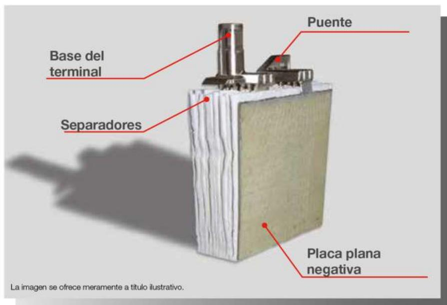
LA GAMA SLA DE FIAMM INCORPORA LA TECNOLOGÍA AGM (DEL INGLÉS "ABSORBED GLASS MAT"): EL ELECTROLITO LO ABSORBE POR COMPLETO UN SEPARADOR DE MICROFIBRA DE VIDRIO Y LA EFICIENCIA DE RECOMBINACIÓN DE LOS GASES INTERNOS ES DE 99 %. LOS MONOBLOQUES SON ROBUSTOS, HERMÉTICOS Y NO REQUIEREN RECARGA DURANTE EL PERIODO DE VIDA ÚTIL DE LA BATERÍA. EL MENOR NIVEL DE AUTODESCARGA GARANTIZA HASTA 6 MESES DE ALMACENAMIENTO SIN NECESIDAD DE RECARGAR.
