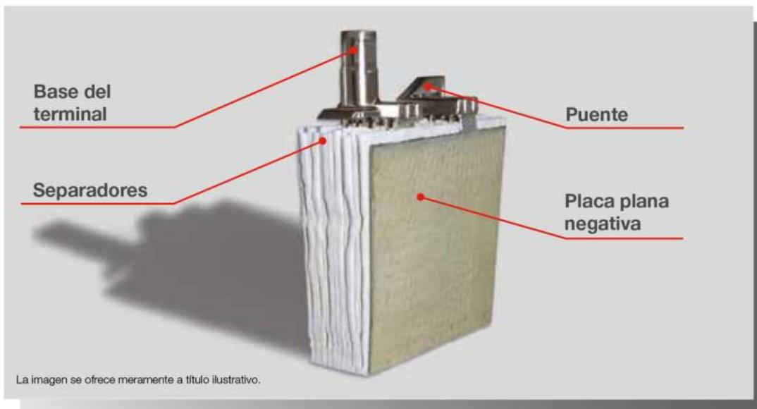
LA GAMA FIT DE FIAMM INCORPORA LA TECNOLOGÍA AGM (DEL INGLÉS "ABSORBED GLASS MAT"): EL ELECTROLITO LO ABSORBE POR COMPLETO UN SEPARADOR DE MICROFIBRA DE VIDRIO Y LA EFICIENCIA DE RECOMBINACIÓN DE LOS GASES INTERNOS ES DE 99 %. LOS MONOBLOQUES SON ROBUSTOS, HERMÉTICOS Y NO REQUIEREN RECARGA DURANTE EL PERIODO DE VIDA ÚTIL DE LA BATERÍA. EL MENOR NIVEL DE AUTODESCARGA GARANTIZA HASTA 6 MESES DE ALMACENAMIENTO SIN NECESIDAD DE RECARGAR.
